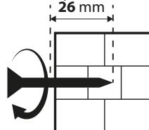
4. Vložte dodané hmoždinky do otvorov, kym nebudú zarovnané s rovinou steny.
