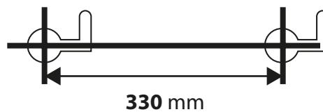
3. Verwenden Sie einen Bohrer, um die Befestigungslöcher zu bohren. Verwenden Sie zum Bohren einen 6 mm langen Bohrer. Die Tiefe der Löcher muss mindestens 26 mm betragen. Verwenden Sie keine kleinere Befestigungsgröße.
