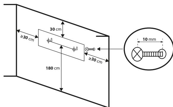
1. Pomocou ceruzky a vodováhy nakreslite na stenu vodorovnú čiaru, do požadovanej výšky.
