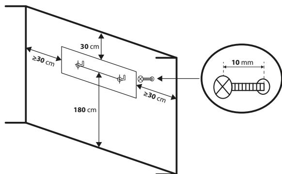
1. Zeichnen Sie mithilfe einer Wasserwaage und eines Bleistiftes eine horizontale Linie in der gewünschten Höhe an die Wand.
