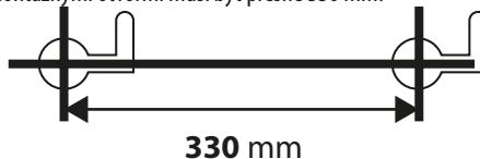
3. Pomocou vrtačky vyvŕtajte montážne otvory. Na vŕtanie použite 6 mm vrták. Hĺbka otvorov musí byť najmenej 26 mm hlboká. Nepoužívajte menšiu montážnu velkosť!
